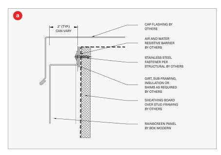
PANEL AT CAP FLASHING
